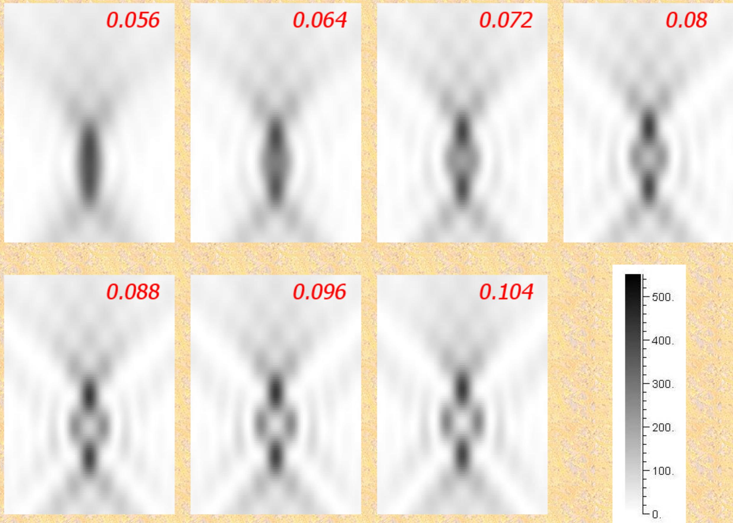
*цифры указывают зазор между двумя ЗП в см.*
