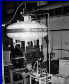
Сверхпроводящий шифтер 7.5 Тесла
