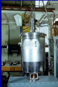
Первая в мире сверхпроводящая змейка с полем 3.5 Тесла
